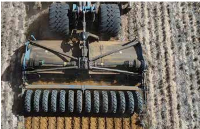
▲ Porte-outils avec une poutre de décompactage rigide d'une largeur de 450 cm. Représenté avec la rotobêche 58SX avec packer à pneus.
