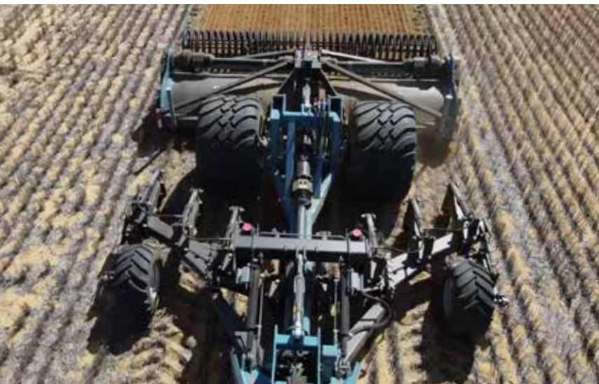
▲ Tracteur avec un décompacteur rigide de 450 cm de large. Représenté avec une rotobèche 58SX avec rouleau à anneaux.
