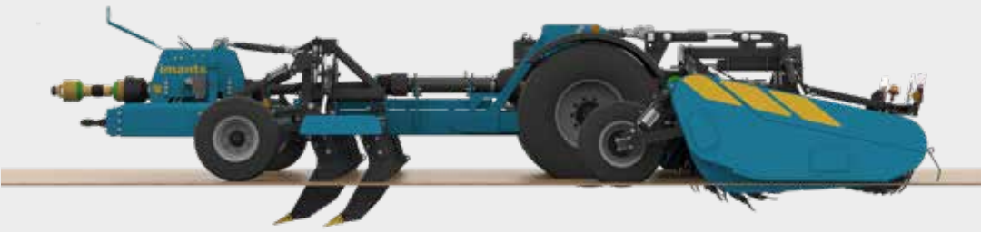
Le modèle 38FSX600H avec 12 pieds de décompactage a été choisi comme illustration. La profondeur de travail des dents du décompacteur peut atteindre 50 cm selon les conditions. L'axe de bêchage et le rouleau émietteur entraîné travaillent à une profondeur de 15 à 35 cm.
