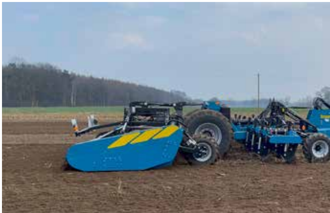
▲ Porte-outils avec poutre de décompactage repliable d'une largeur de 600 cm. Représenté avec la rotobêche 38FSX, largeur de transport (repliée) 300 cm.
