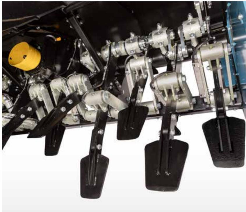
▼ Hier zeigen wir ein Bild der Spatenwelle des Kurbelwellenspatenmaschinen der ST-Serie.
